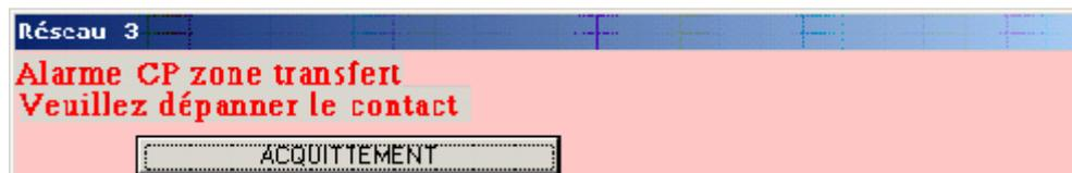
Quand le capteur d'inversion à la zone de transfert est bloqué, le cadre symbolisant ce capteur passe au rouge.
